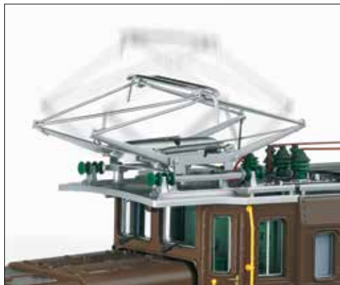
Via de motor op en neer beweegbare stroomafnemer
