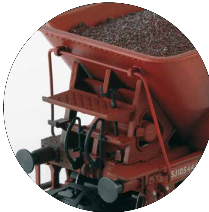
Alle wagens met remplatform en remkruk
