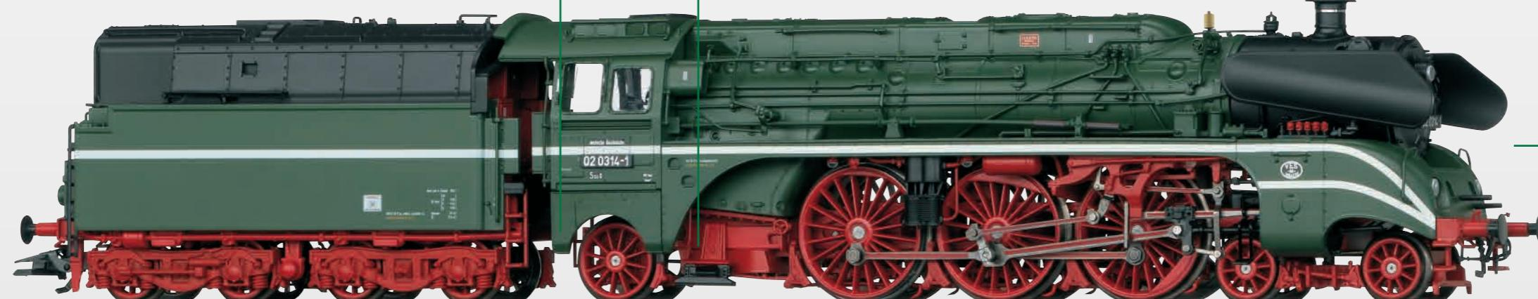
Version du modèle avec chaudière reconstruite et chauffe principale au fuel.
